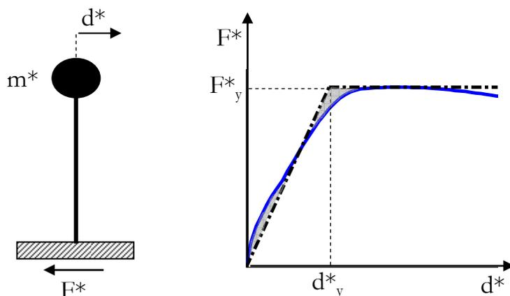
Figura 4.1 – Sistema e diagramma bilineare equivalente
