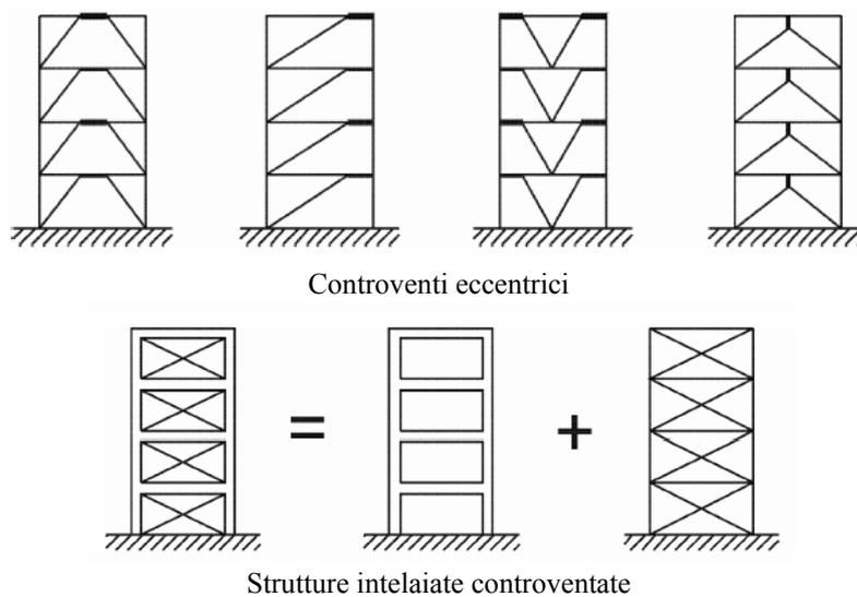
Figura 6.1. Tipologie strutturali
