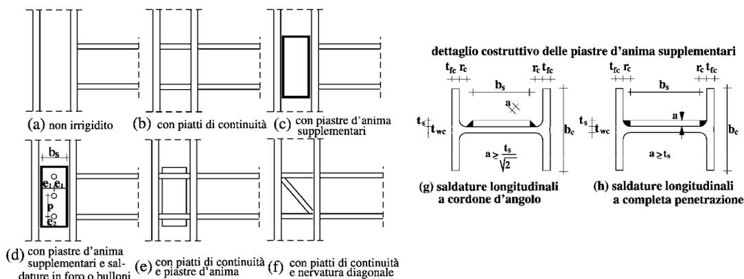
Figura 6.2. Dettagli costruttivi di pannelli nodali irrigiditi.
