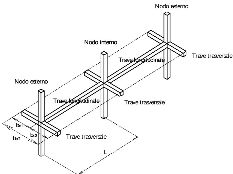
Figura 7.5 - Definizione degli elementi in una struttura intelaiata.
